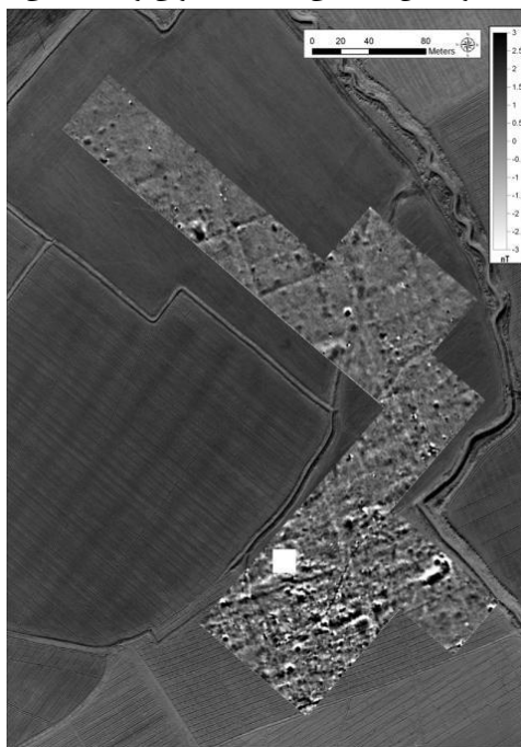
شکل ۴. نقشه ژئومغناطیس زمینه‌ای اطراف تخت جمشید که بدون حفاری و فقط با اندازه‌گیری شدت و جهت میدان مغناطیسی توسط دستگاه گرادایومتر به دست آمده و ساختارهای معماری و بناهای متعددی را آشکار کرده است (بحرالعلمی، ۱۳۹۳)
